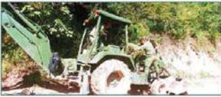
**Lunes 2 de noviembre de 2021.** esta fecha, la célula de mantenimiento del Batallón de Parque de Ingenieros, realizó el mantenimiento preventivo al cargador frontal con retroexcavadora, consistente en cambio de aceites, filtro, así como la revisión de la marcha y alternador, quedando mencionada retroexcavadora en estado operativo.
