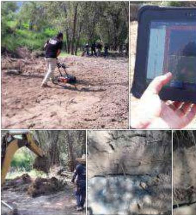
Rastreo con el georadar, sin obtener alteraciones de importancia, así como dos calas realizadas de 5 mts de largo por 2 mts de ancho y 2 mts. de profundidad; en la primera sin obtener indicios y en la segunda localizando lo siguiente:
