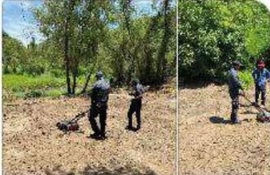
Barrido del área con apoyo de Georradar, arrojando posible alteración del terreno a 2.5 mts. de profundidad, observando también filtraciones de agua debido a la cercanía del río balsas, también se llevó a cabo el barrido con el binomio canófilo sin mostrar interés en los puntos varrillados.
